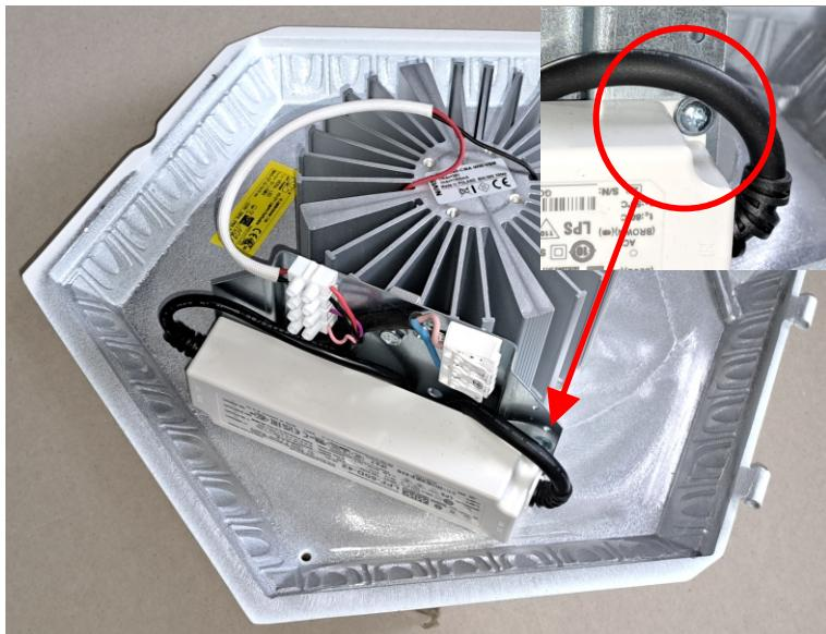
1. Przed przystąpieniem do demontażu modułu należy odłączyć oprawę oświetleniową od zasilania sieciowego. Kolejnym krokiem jest odłączenie przewodów z zasilacza, poprzez wypięcie ich z listwy zaciskowej. Następnie za pomocą śrubokręta krzyżowego, wykręcamy dwa wkręty mocujące zasilacz.
