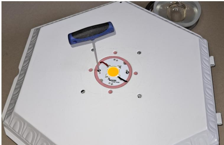
3. Za pomocą klucza imbusowego, należy wykręcić wkręty i zdemontować holder modułu.
